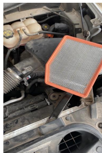
CAMBIO DE FILTRO DE AIRE
