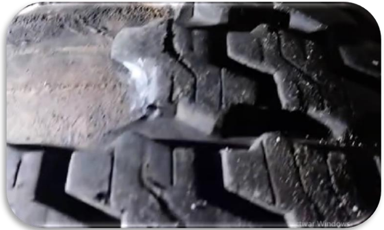
DELANTERA COPILOTO DAÑADA
