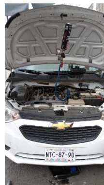
LAVADO DE INYECTORES
