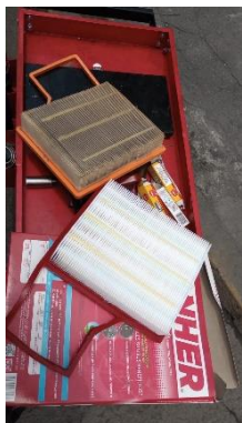
CAMBIO DE FILTRO DE AIRE
