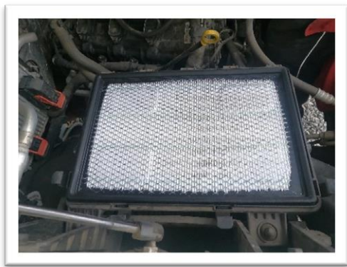
CAMBIO DE FILTRO DE AIRE
