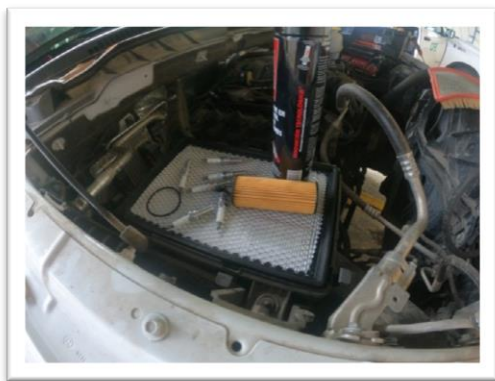
CAMBIO DE FILTROS Y BUJIAS
