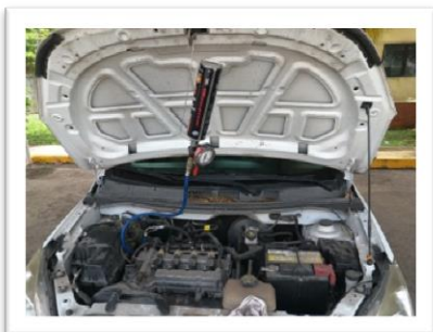
LAVADO DE INYECTORES
