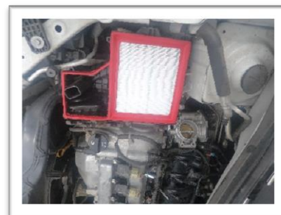
CAMBIO DE FILTRO DE AIRE
