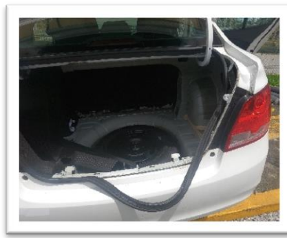
SE DESMONTA MOLDURA PARA REPARACION DE ABS
