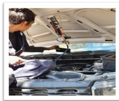
LAVADO DE INYECTORES
