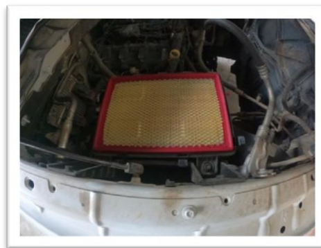
CAMBIO DE FILTRO DE AIRE
