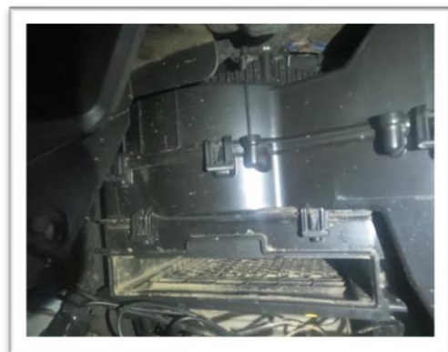
FALTA FILTRO DE POLEN Y TAPA
