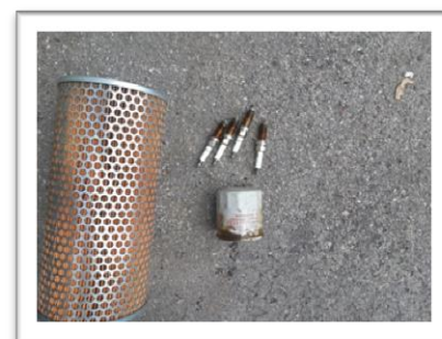
CAMBIO DE FILTROS Y BUJIAS
