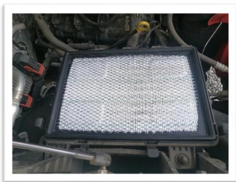
CAMBIO DE FILTRO DE AIRE
