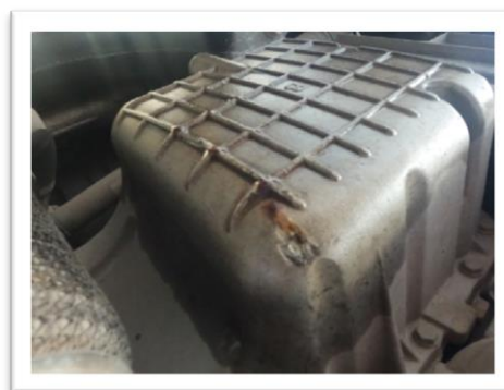
CARTER EN MAL ESTADO
