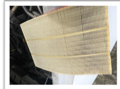
CAMBIO DE FILTRO DE AIRE
